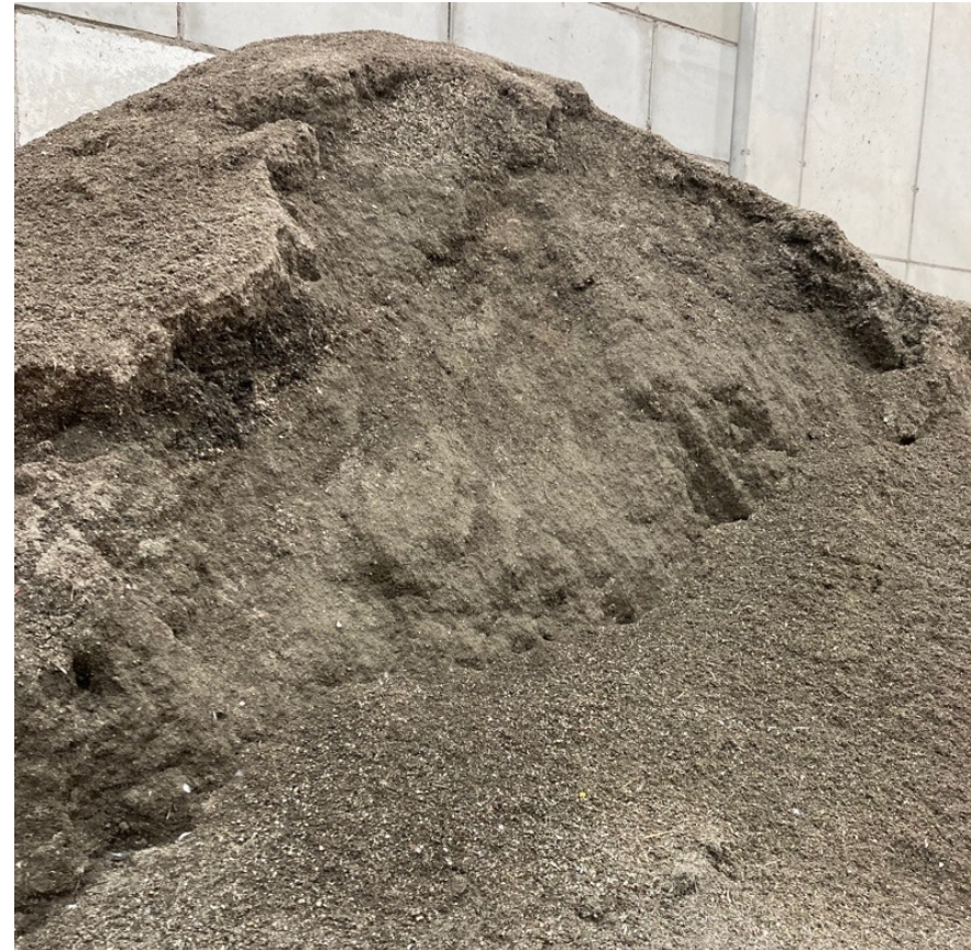
Feinkorn, Fraktion 0 – 12 mm, aus einer Baumisch- und Gewerbeabfallsortieranlage
