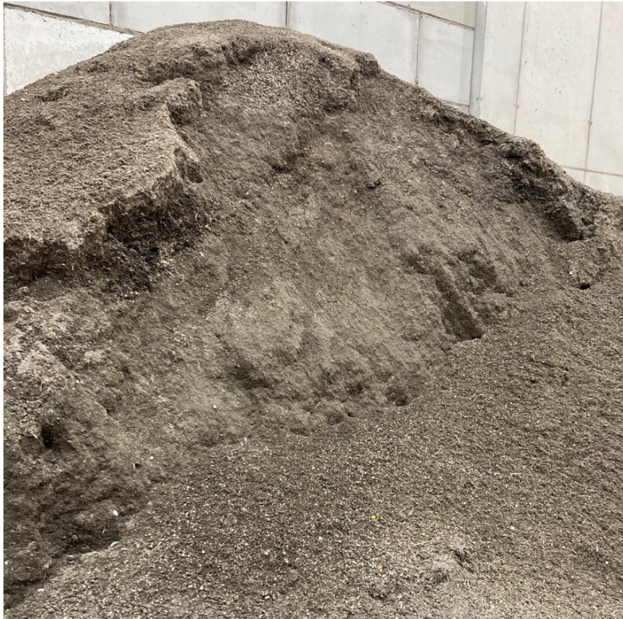
Feinkorn (0 – 12 mm) aus einer Sortieranlage für Baumisch- und Gewerbeabfälle
