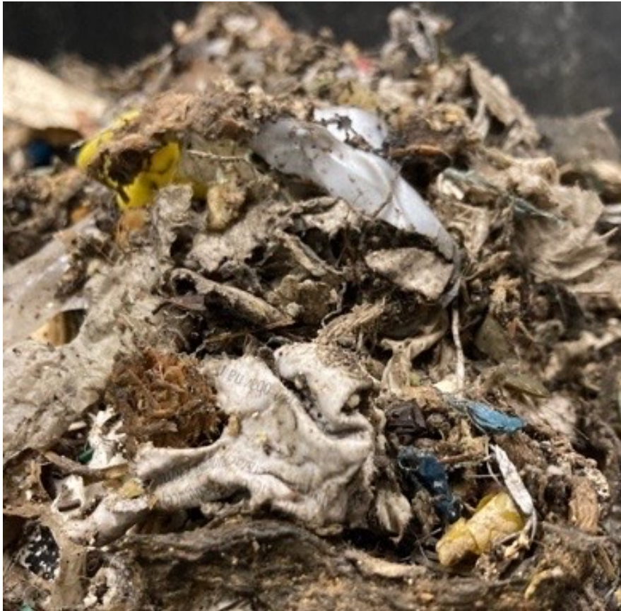
Restabfall, Fraktion 0 – 40 mm, aus einer mechanisch-biologischen Restabfall-behandlungsanlage
