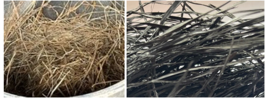
Aufwuchs vor (li.) und nach (re.) der Batch-Pyrolyse
